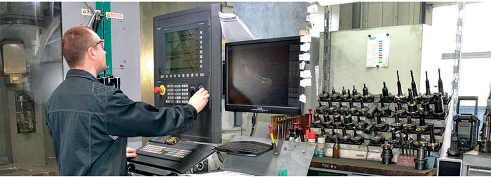
2 Der Maschinenbediener sieht nur freigegebene Fertigungsaufträge und arbeitet sie entsprechend der in ProLeiS vorgegebenen Reihenfolge ab © Tebis
